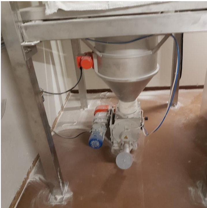
Figur 10 Forbindelsestragten fra BigBaggen til pumper der pumper melet videre.
