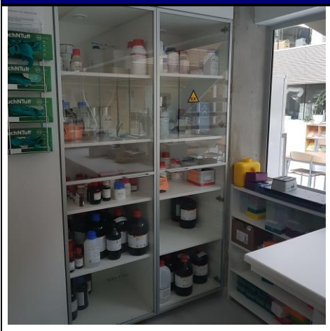
Figur 3 Oplag i laboratorier i ventilerede skabe
